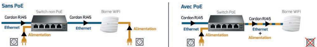
► Schéma d’illustration du câblage pour une installation en PoE.
